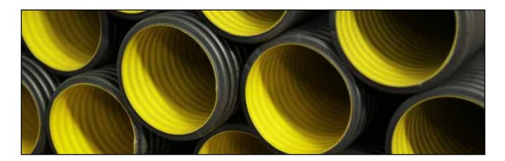
Kalde Koruge boru sistemleri polietilen (PE) hammaddesinden TS EN 13476-3 standartlarına uygun olarak SN4 ve SN8 halka sertliklerine uygun olarak iç çap tanımlamasına göre DN100, DN150, DN200, DN250, DN300 çaplarında ve 6 metre boylarında ekstrude olarak üretilmektedir.
